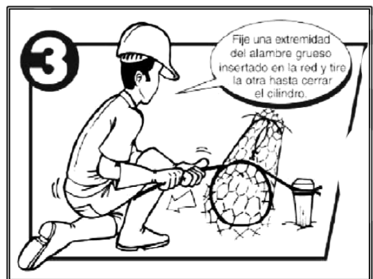
Figura 16. Amarre de los extremos. Fuente: (Morassutti F, 2013)
