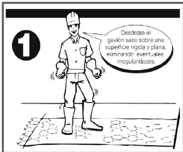
Figura 16. Preparación de malla sobre una superficie plana. Fuente: (Morassutti F, 2013)
